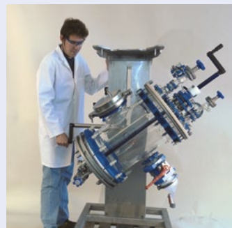
Tilting of 30 liter filter vessel for discharge Drehung des 30 Liter Filtergefäßes zur Entleerung
