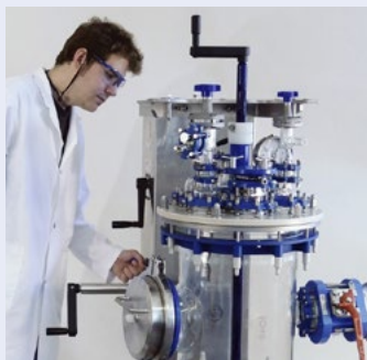
Lowering of filter vessel Absenken des Filtergefäßes
