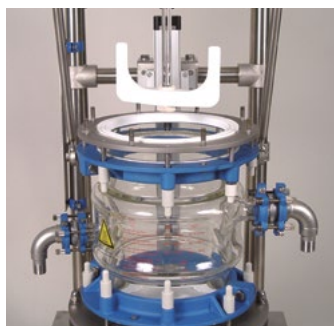
10 liter Solid phase peptide reactor with heating jacket 10 Liter Peptid-Festphasensynthesereaktor mit Heizmantel
