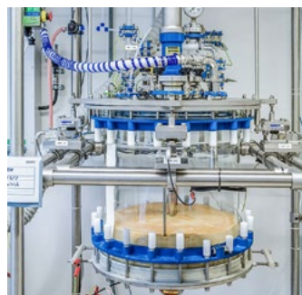
100 liter peptide synthesizer on load cells, fully automated dosing from feed battery, ATEX 100 Liter Peptid-Reaktor auf Wägezellen, vollautomatisierte Dosierung von Zulauf-Batterie, ATEX
