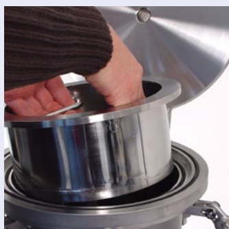
Easy removal of filter cake Einfache Entnahme des Filterkuchens
